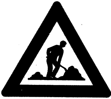
(K-20) Κίνδυνος λόγω εκτελουμένων έργων επί της οδού.
