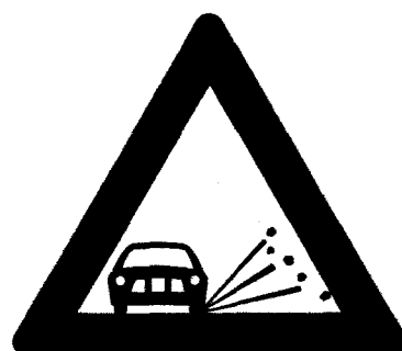
(K-13) Ἐπικίνδυνος ἐκτίναξις χαλίκων, (ἀσύνδετον ἀμμοχάλικον).
