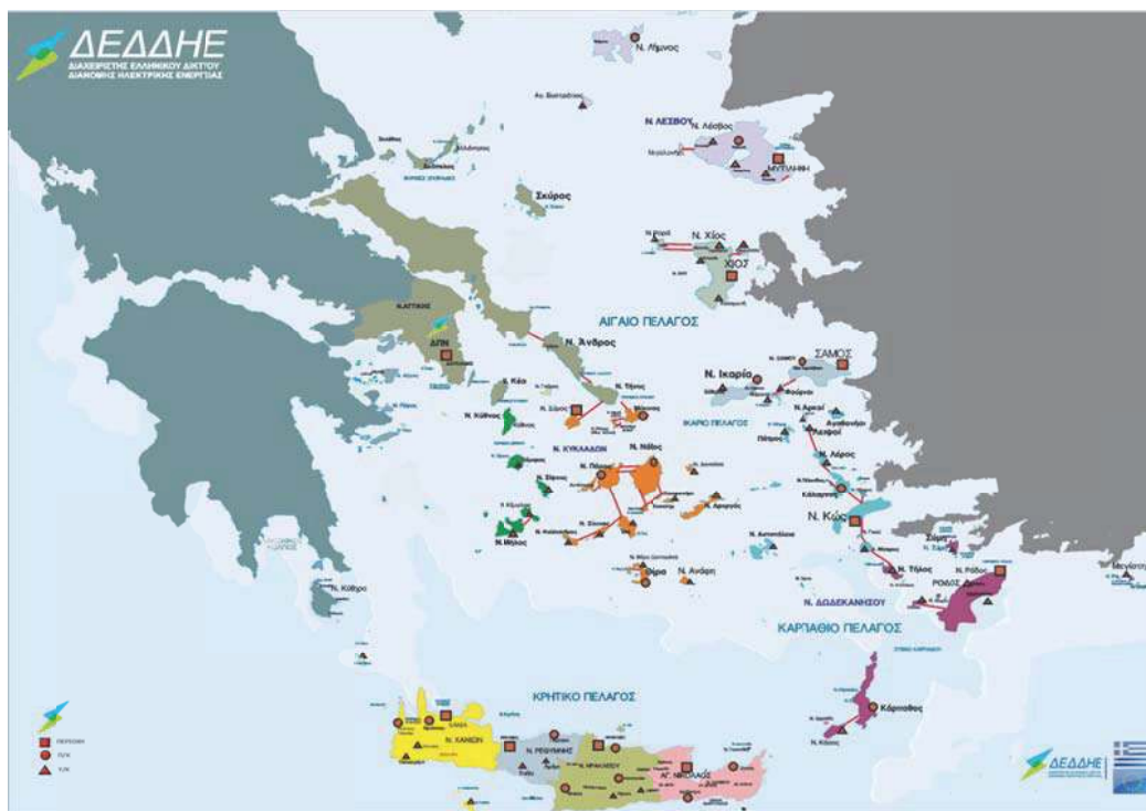
Σχήμα 21: Διασυνδέσεις νησιών Αιγαίου υπό ΜΤ (πηγή ΔΕΔΔΗΕ)
