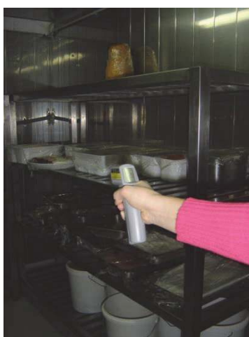
Εικόνα 30:Θερμομέτρηση ψυκτικού θαλάμου
