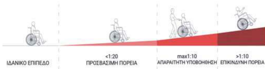
Σχήμα 3: Κίνηση χρήστη αναπηρικού αμαξιδίου σε ράμπα
