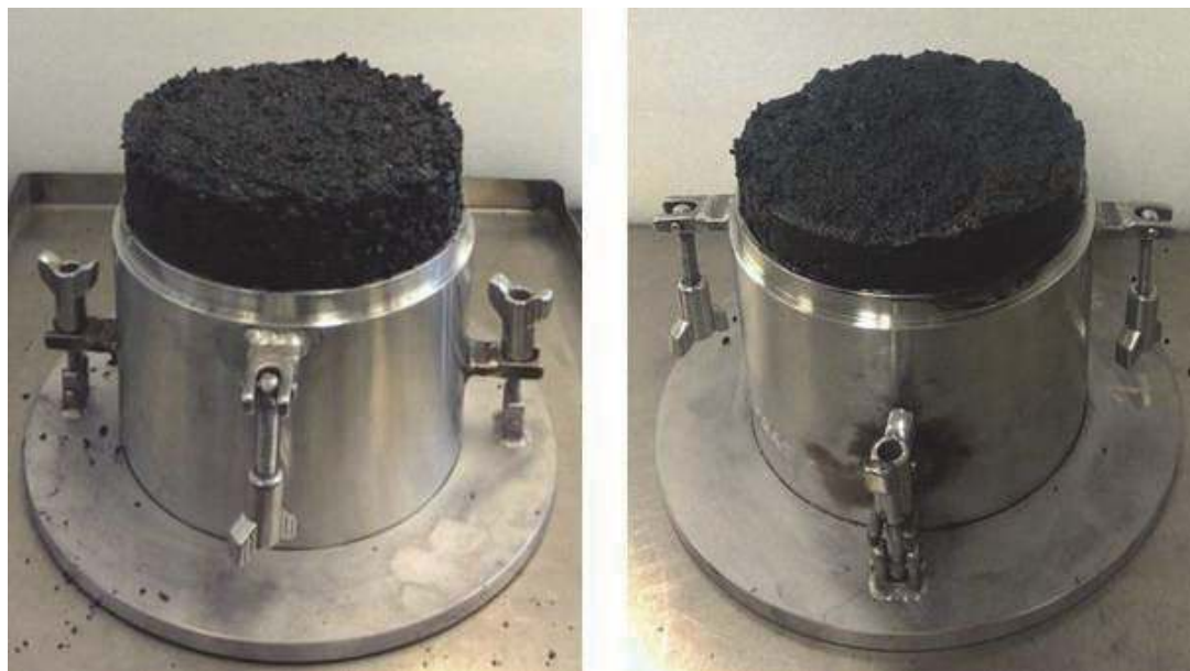
Εικόνα 1.5.7 Φωτογραφίες που δείχνουν έγκυρες δοκιμές για μερικώς κορεσμένο τμήμα δοκιμής (αριστερά) και τμήμα σχεδόν πλήρως κορεσμένου δείγματος (δεξιά)
