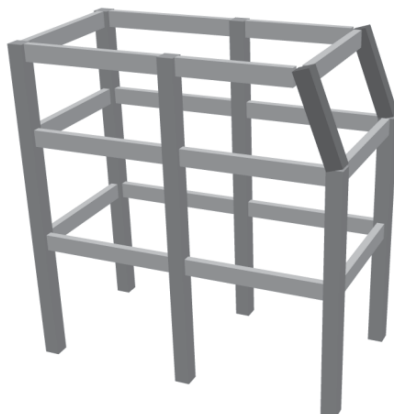
Κεκλιμένα (λοξά) υποστυλώματα (ΚΑ 5 )
