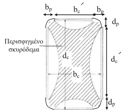
Σχ. Σ6.9β Περίσφιγξη με ινοπλισμένα πολυμερή-στρογγύλευση γωνιών
