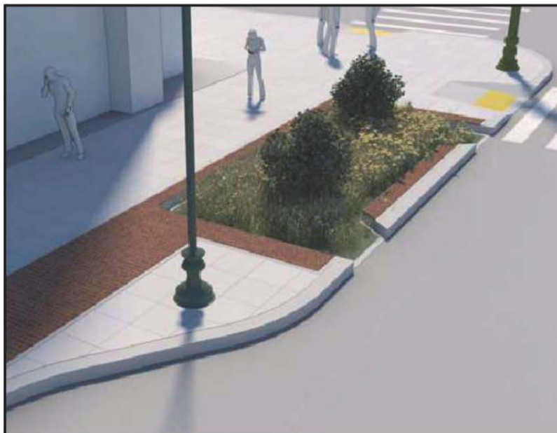
ΣΧ.22-Κανάλια βιοφιλτραρίσματος - Biofiltration swales
