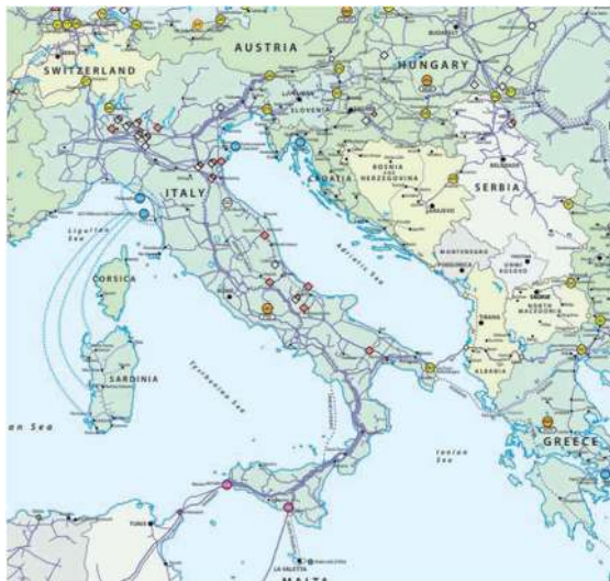
Σχήμα 10: Το Σύστημα Φυσικού Αερίου της Ιταλίας
