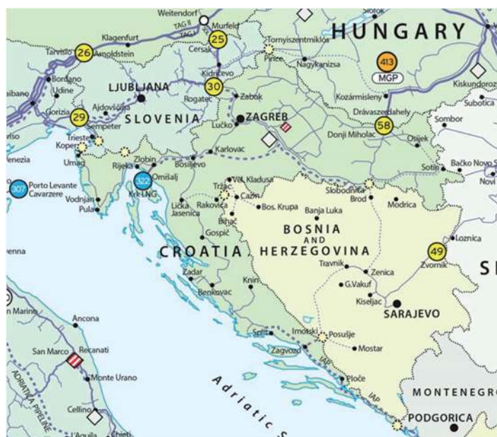
Σχήμα 8: Το Σύστημα Φυσικού Αερίου της Κροατίας
