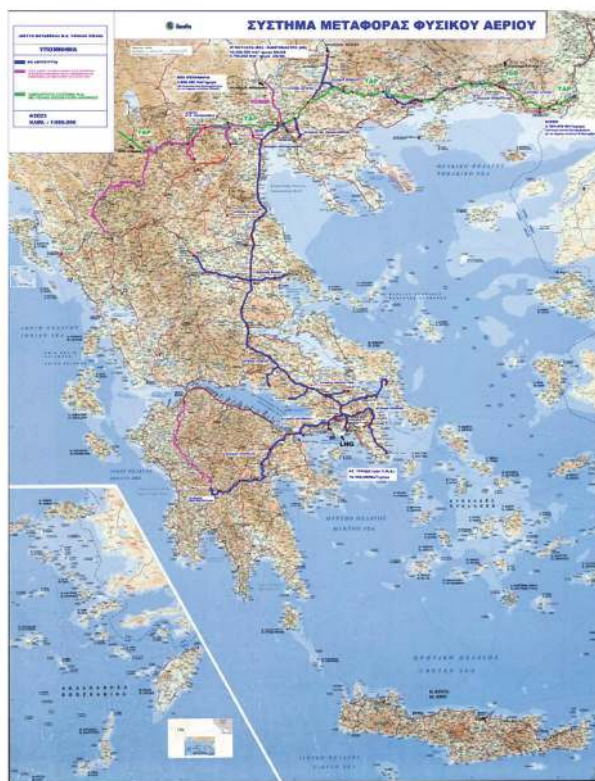
Σχήμα 24: Εθνικό Σύστημα Αγωγών Φυσικού Αερίου (πηγή: ΔΕΣΦΑ)
