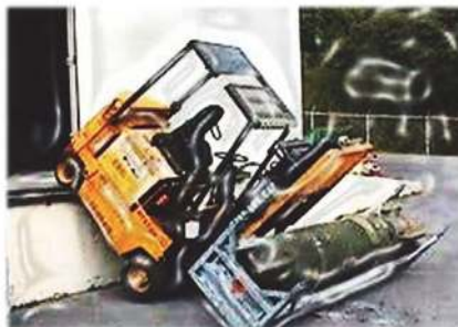
Πτώση μηχανήματος από ύψος, λόγω κακού χειρισμού ή άλλου παράγοντα Πηγή: UESSE Italia S.p.A. (2023). Formazione per i Lavoratori Addetti alla Conduzione di Carrelli Elevatori Semoventi con conducente a Bordo.
