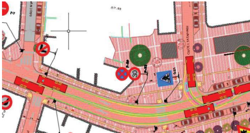
Οδός Ταταράκη δυσμενέστερες οπισθοτροχίες φορτηγού 10μ και διαπλάτυνση καμπύλη ΠΕΟ
